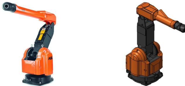
FIGURE 1 – Vue réelle et modèle numérique pour analyse dynamique sous modeleur CATIA
