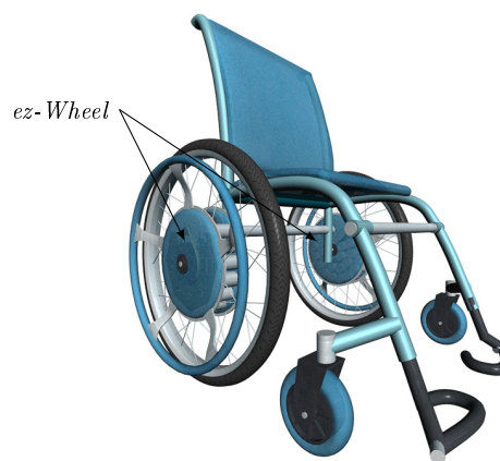
FIGURE 2 – Prototype de fauteuil roulant équipé de deux ez-Wheel
