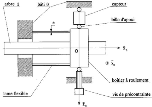
L'arbre **1** (avec la poulie), de masse  $m_1$ , a pour moment d'inertie  $I_1$  par rapport à l'axe  $(O, \vec{x}_0)$  et est équilibré en rotation.
