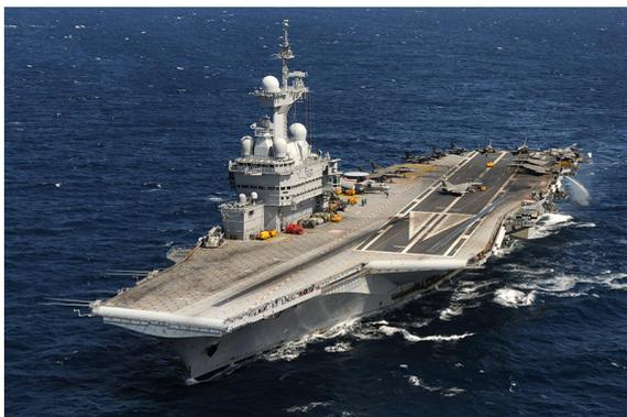
Malgré les dimensions du pont d'envol (260 m de long et 65 m de large), les pistes sont réduites, environ 70 m pour celles de décollage et 100 m pour celle d'appontage.
