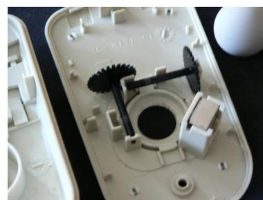
Chaque rouleau communique ses rotations à un petit disque, appelé encodeur (du type codeur incrémental). L'encodeur est constitué d'un disque dont sa périphérie est constituée d'alternance de dents (présence de matière et absence de matière), d'un émetteur de lumière (photodiode émettrice) et d'un récepteur de lumière (phototransistor récepteur). Le comptage des dents permet de mesurer le déplacement.
