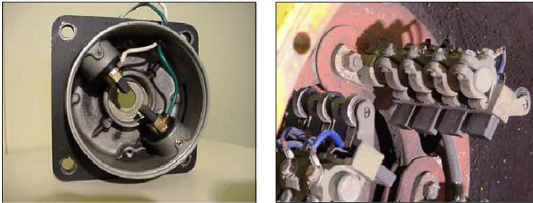
FIGURE 3 – Les balais d'un Moteur à Courant Continu
