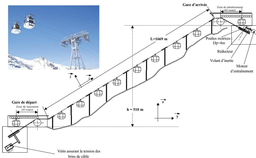
FIGURE 1 – Description structurelle du système à double conduite
