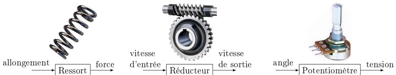
FIGURE 10 – Exemples de systèmes modélisables par un gain pur
