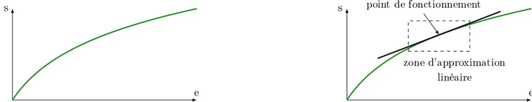
FIGURE 7 – Linéarisation d'un système non linéaire au voisinage d'un point
