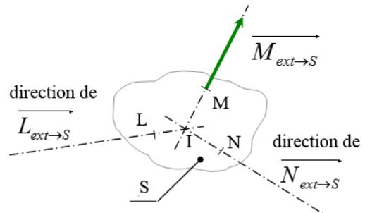
On recopie la force connue à côté du dessin, puis on trace les parallèles aux directions des 2 autres forces passant par les extrémités du vecteur-force connu. On obtient ainsi un triangle.
