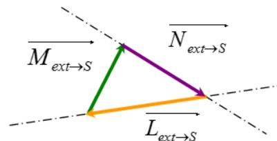
On mesure enfin les deux vecteurs qu'on vient de tracer et on calcule la valeur des efforts correspondants en fonction de l'échelle.
